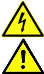
Simbol munje unutar trokuta upozorava korisnika da ovaj uređaj sadrži neizolirane električne dijelove. Postoji opasnost od strujnog udara.
