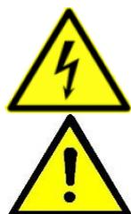
Simbol strele v trikotniku opozarja uporabnika, da ta naprava vsebuje neizolirane električne dele. Obstaja nevarnost električnega udara.
